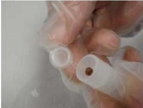
En algunos análisis de MMC la tapa de plástico contiene una perla catalizadora que, una vez se inserta el material para analizar en la ampolla, se debe mezclar utilizando la punta redonda de la espátula.
