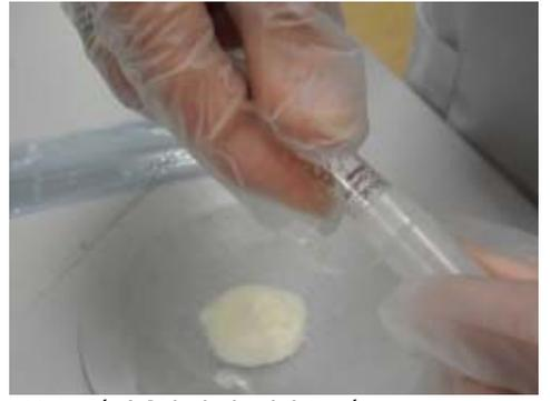
¡Atención! Si la bola del tapón se engancha en un lado, utilice la espátula para sacarla, introdúzcala en la ampolla y mézclela. Coloque el tapón de plástico en la parte superior de la ampolla.
