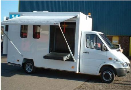
Camión escáner de rayos-X móvil para equipajes
