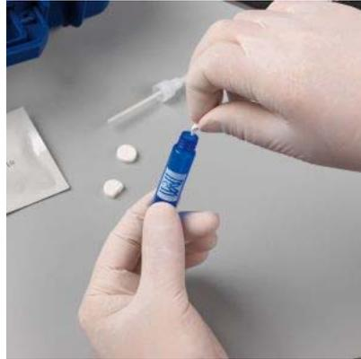
Coloque una pequeña parte del sólido o comprimido en el contenedor de solución reguladora especial de MMC (\*Cannabis (THC) / comprimidos, deje la botella durante 4-5 minutos antes de analizar)
