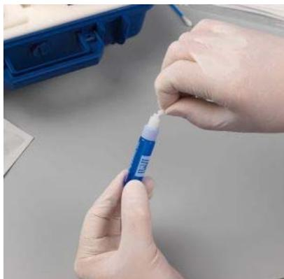
Sujete el contenedor de solución reguladora con una mano y arranque la punta para que sea un gotero
